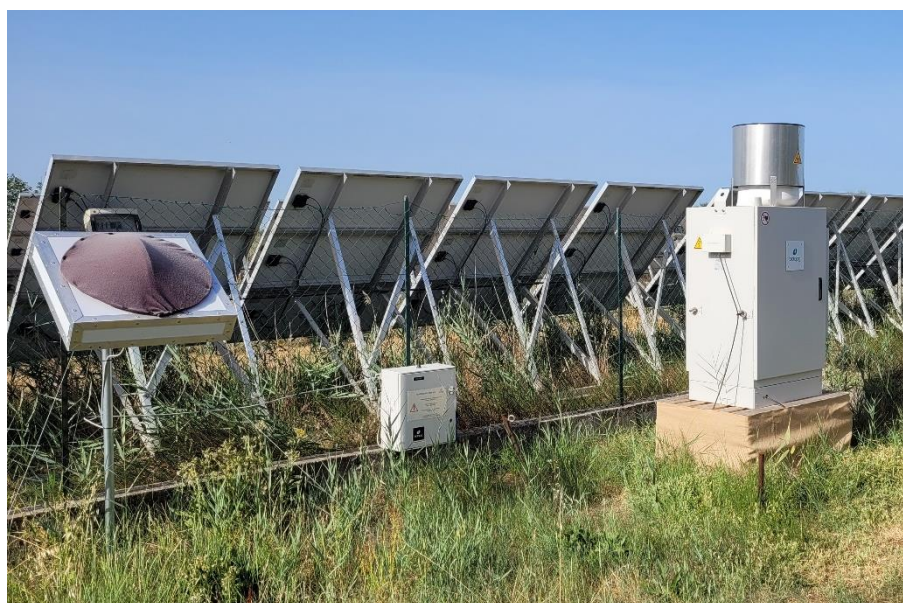
Figure 2 : DISPOSITIF ACOUSTIQUE OISEAUX AVEC LA PARABOLE (A GAUCHE) ET COFFRET CONTENANT L'ENREGISTREUR (AU CENTRE)
