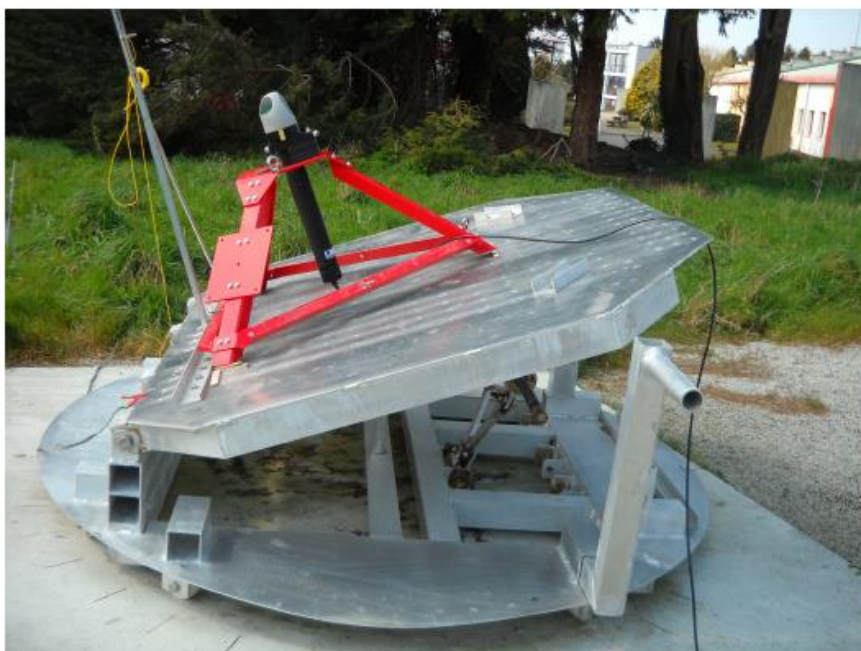
Figure 6 : Plateforme inclinée à 20 °. Bras de poussée au premier plan.
