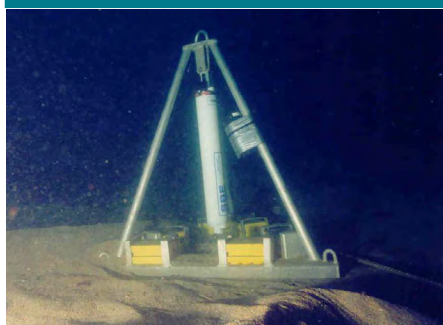
Un marégraphe (1,5 m 2 au sol, 12 Kg)
