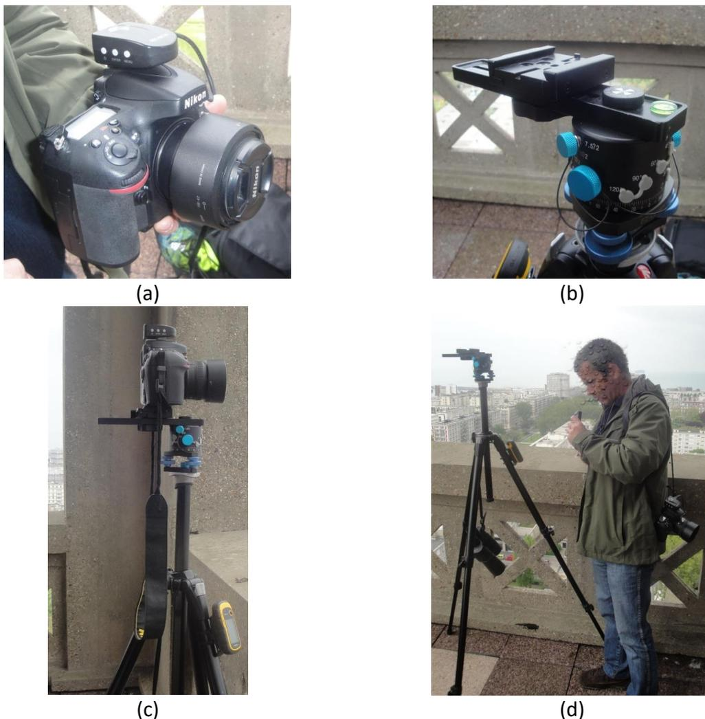
**Figure 10 : prise de vue panoramique. (a) l'APN utilisé. (b) La tête panoramique. (c) L'ensemble est calibré afin que la rotation s'effectue autour du point nodal de l'appareil. (d) Les prises de vue sont complétées par des mesures GPS et des annotations vocales.**
