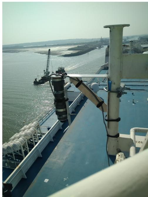
Dispositif acoustique installé sur ferry
