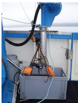
Figure 2 : Caméra sous-marine. (Cliché TBM)
