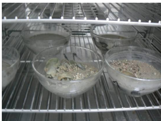
Figure 13 : Echantillons granulométriques à l'étuve (Cliché TBM).
