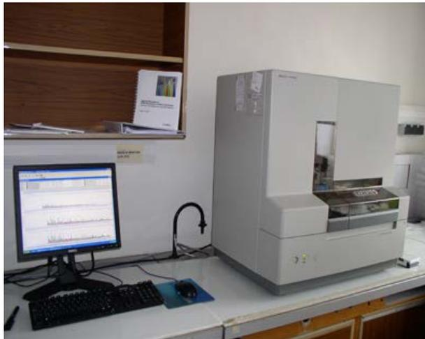
Analyseur ADN (ou séquenceur, 3130 Applied Biosystem) permettant l'électrophorèse sur 4 capillaires de 50 cm.
