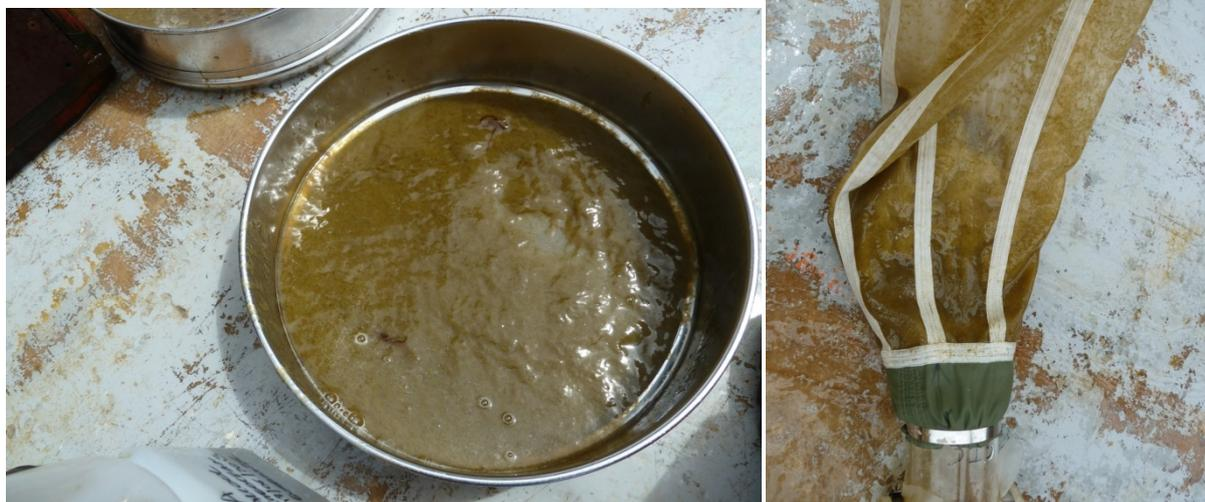
Photo 2.2 : Refus de tamis avec mucus et extrémité du filet colmaté
