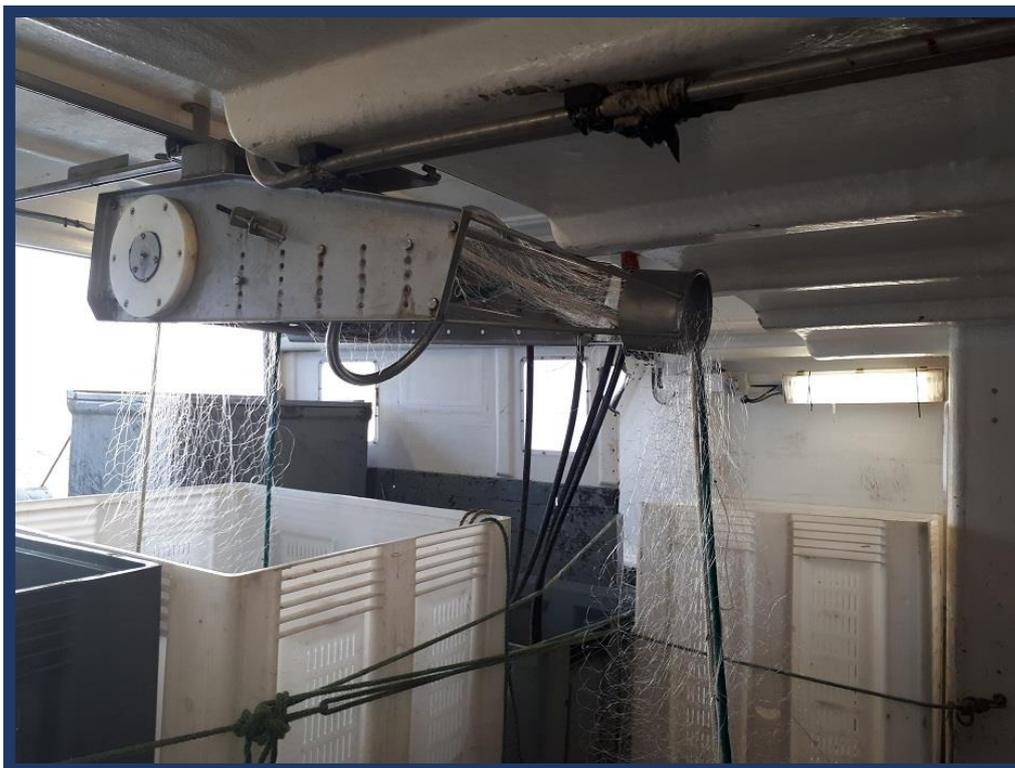
Figure 39: Filet trémail passant dans la pomailleuse, engin servant à le démêler.
