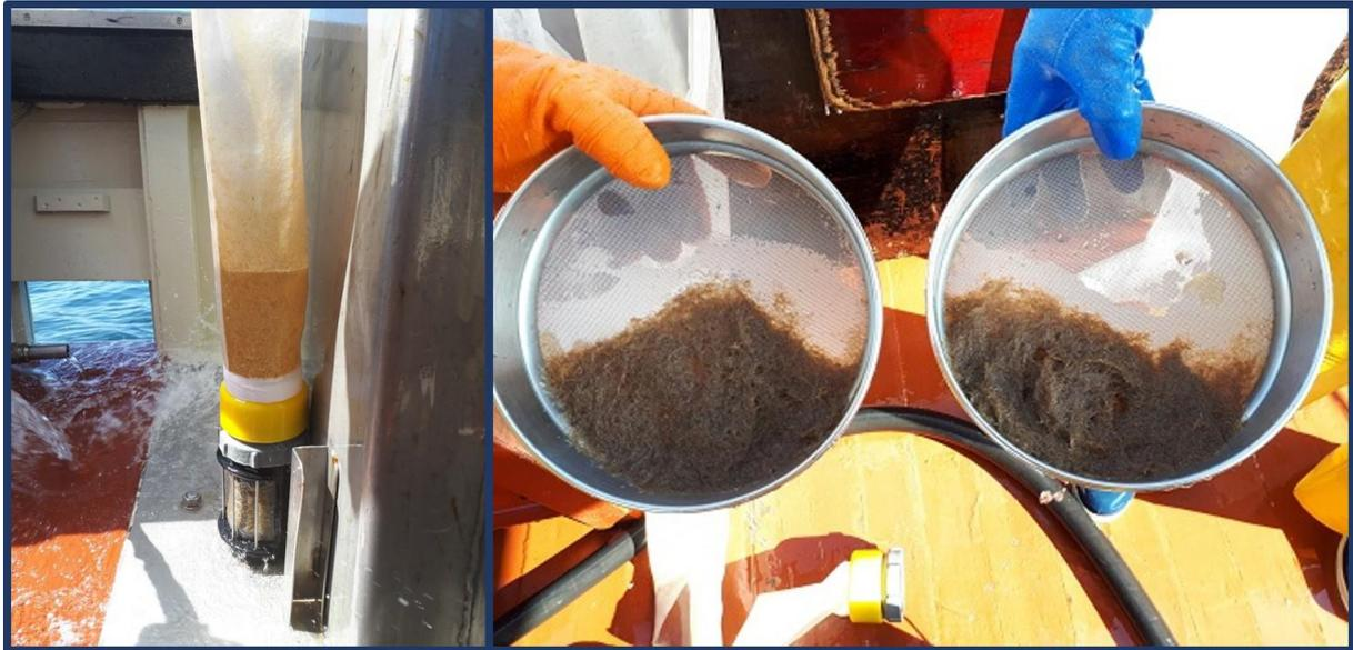
Figure 32: Colmatage partiel du filet – Refus de tamis importants.
