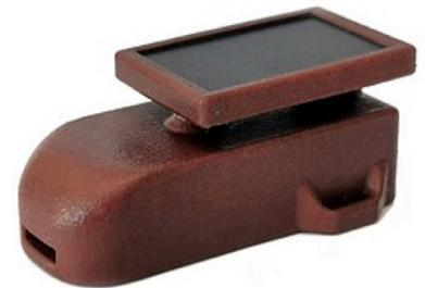
Ces balises GPS sont programmées pour enregistrer la position géographique des individus et envoyer ces positions à une plateforme de téléchargement via le réseau GSM. Grâce aux panneaux solaires et au téléchargement régulier des données, les balises devraient permettre l'acquisition de données pendant une année, nous permettant de connaître la distribution spatiale des oiseaux reproducteurs pendant la période de reproduction mais également au cours de la dispersion postnuptiale.
