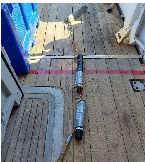
Sonde multiparamètre avec balise USBL montée sur un bas de ligne à tracter
