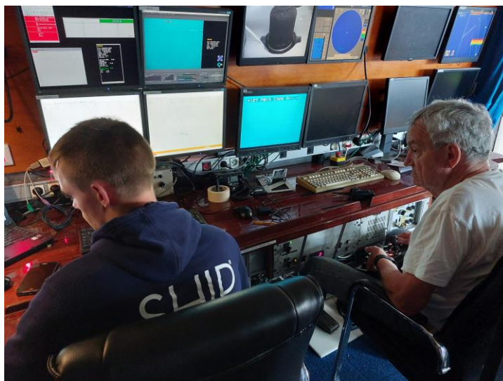
Figure 7 : Poste de pilotage et de contrôle du ROV
