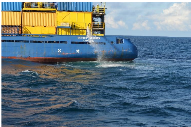
Pas de trace de turbidité particulière dans les eaux de rejet du SEEHORN
