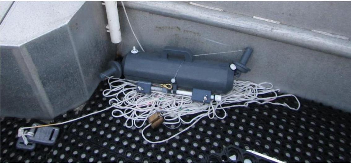
Figure 4 : Bouteille Niskin utilisée pour les prélèvements d'eau et la mesure du MES
