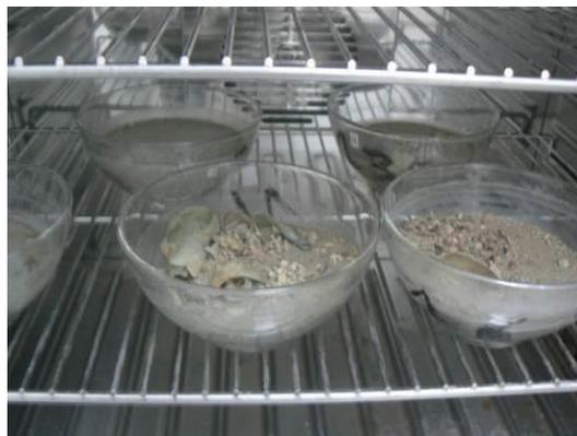
Figure 11 : Echantillons granulométriques à l'étuve
