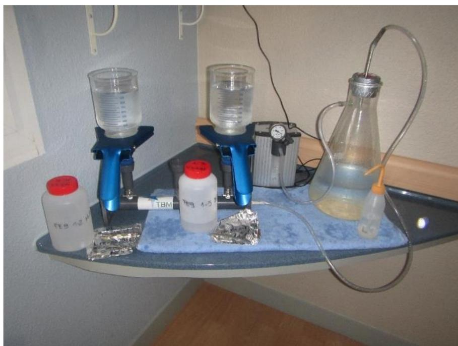
Figure 6 : Filtration des échantillons d'eau au laboratoire.
