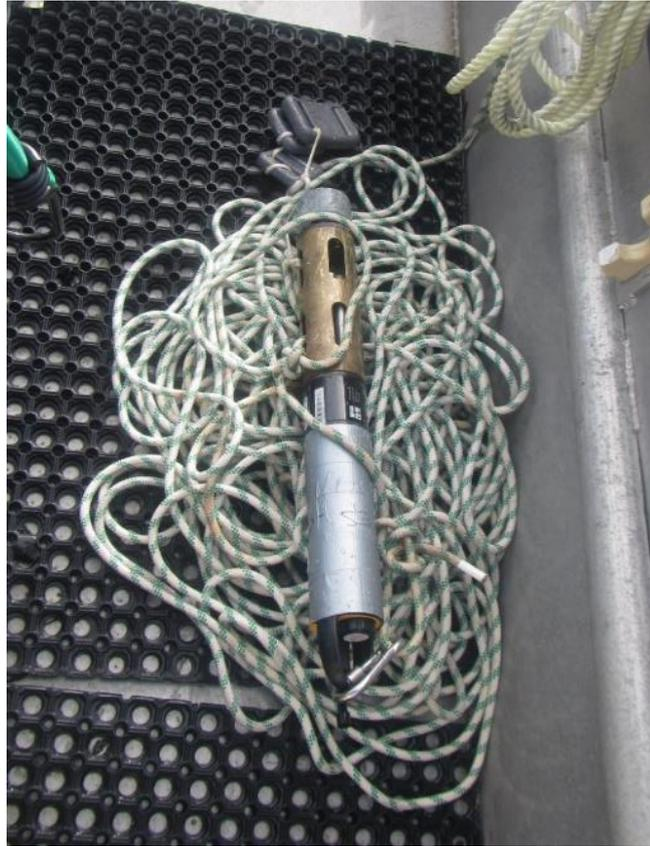
*Figure 7 : Sonde YSI Exo 3 utilisée pour la réalisation des profils*
