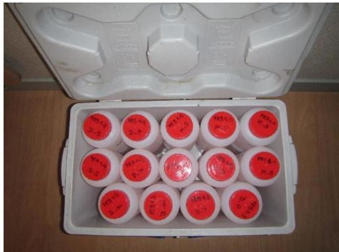
Figure 5 : Conservation des prélèvements d'eau en glacière jusqu'au laboratoire.
