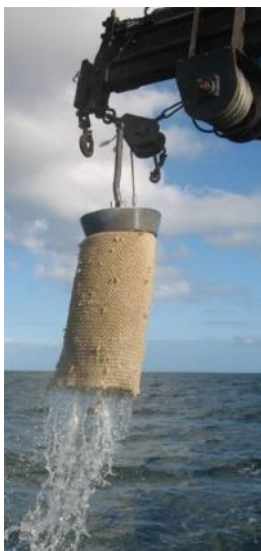
Figure 3 : Drague rallier du Baty et schéma descriptif de son mécanisme de fonctionnement (Trigui, 2009)
