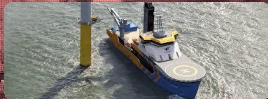
Systèmes de propulsion des navires moins carbonés (CTV électriques H2)
