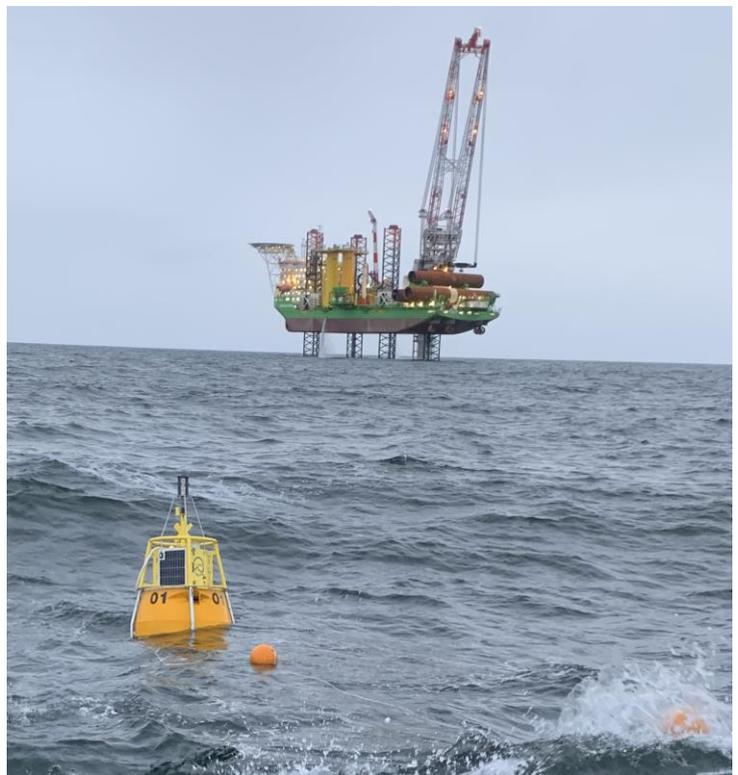
Figure 6 : Bouée temps réel Smart-PAM (source Quiet-Oceans).
