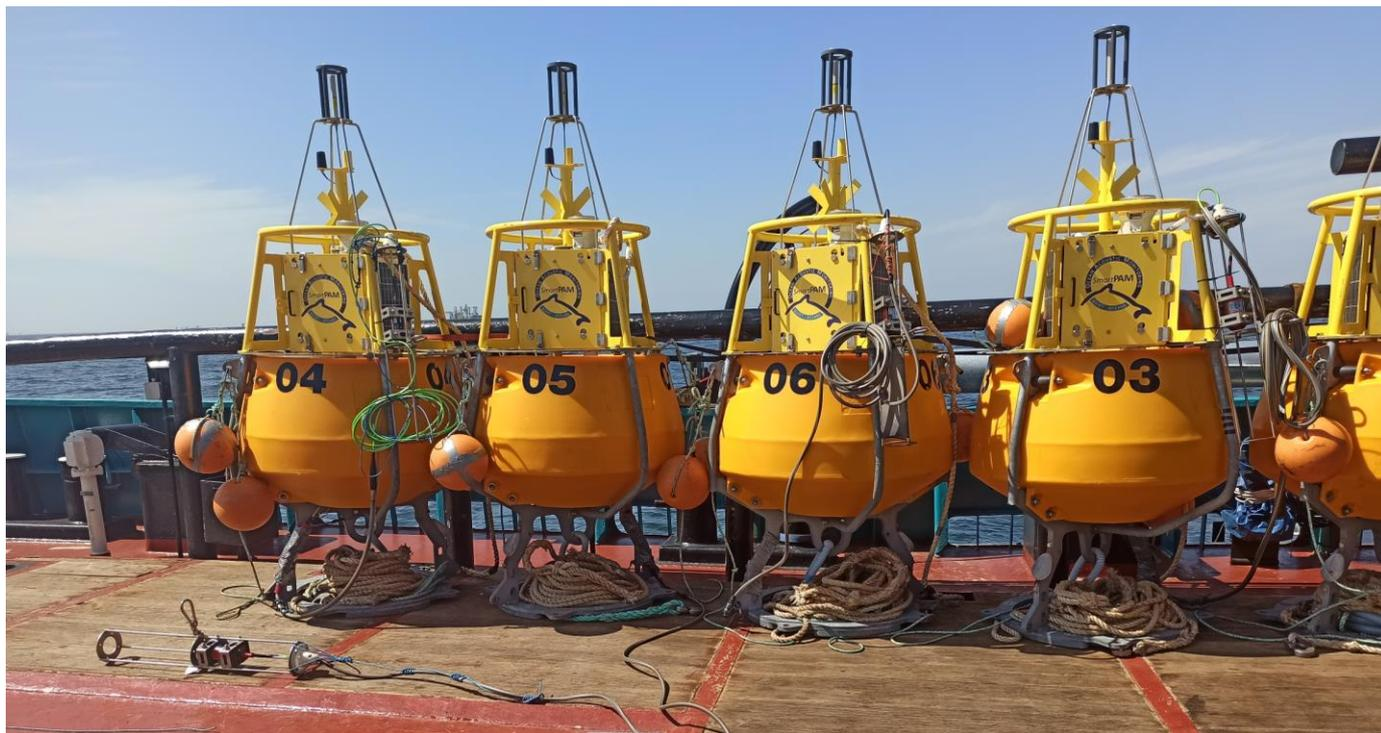
Figure 7 : Bouées Smart-PAM sur pont du navire Alma Kappa (source Quiet-Oceans)
