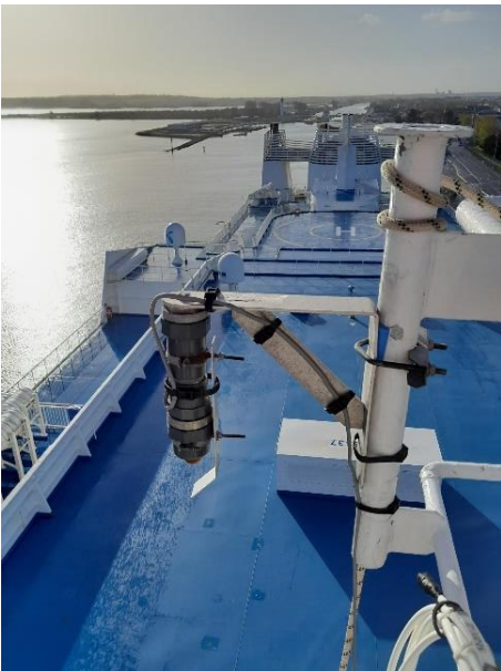
Figure 30. Illustration du microphone et de son système de protection dans son environnement.
