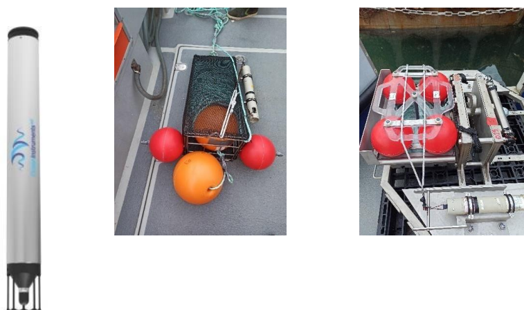
Figure 21. Enregistreur acoustique autonome (à gauche), flotteur subsurface avec panier (au centre) et cage de fond (à droite).
