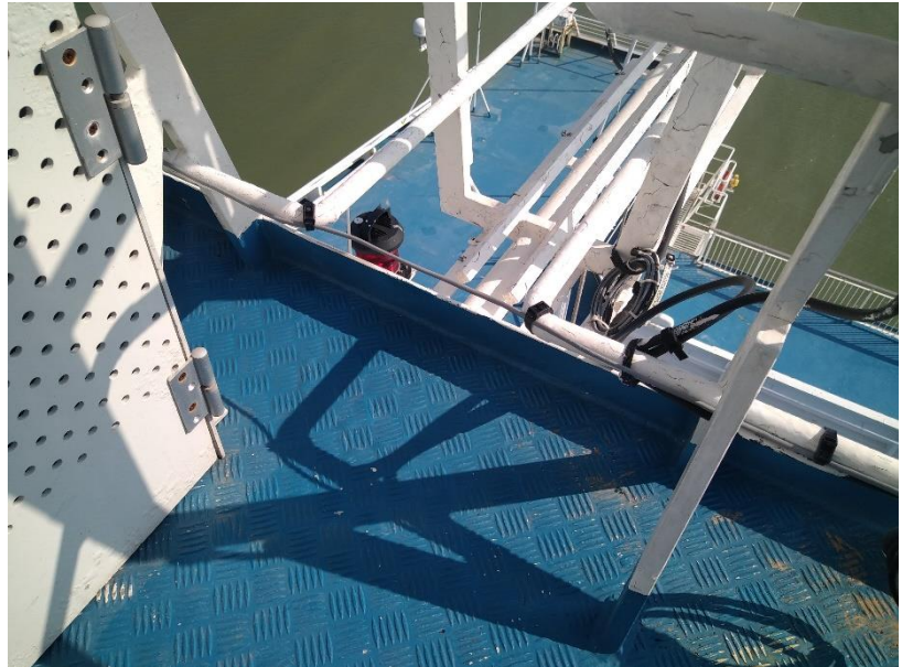
Figure 29. Illustration des passages de câbles reliant le microphone au dispositif de collecte autonome.
