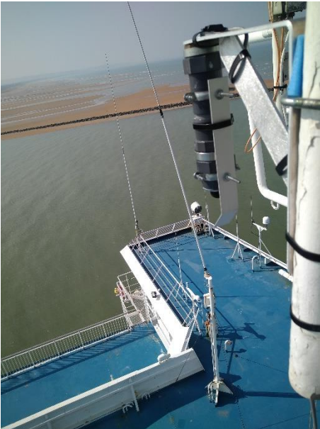
Figure 28. Illustration du microphone et de son système de protection.
