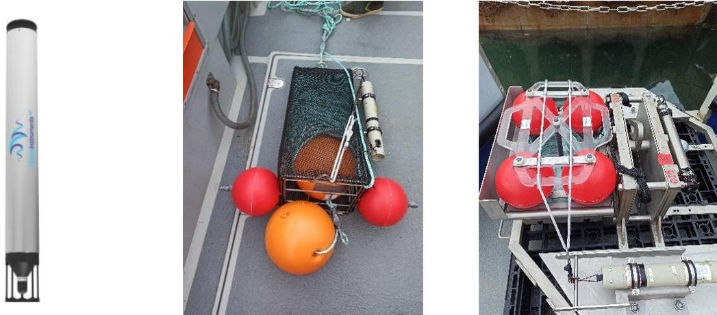
Figure 9 : Enregistreur acoustique autonome (à gauche), flotteur subsurface avec panier (au centre) et cage de fond (à droite).
