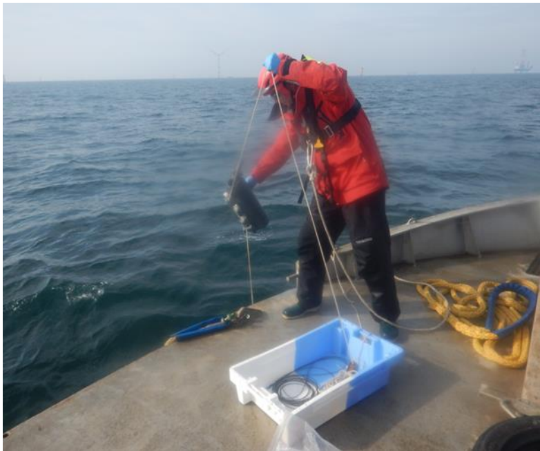
Figure 8. Prélèvements d'eau à l'aide de la bouteille Niskin
