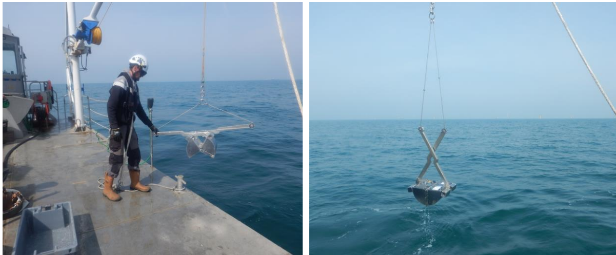
Figure 25. Utilisation de la Benne Van Veen : surface d'échantillonnage de 0,1 m 2
