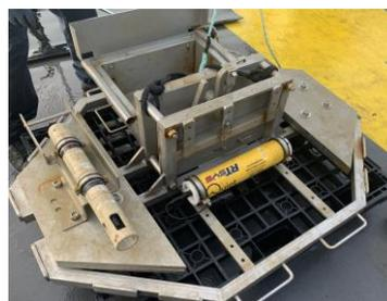
Figure 9 : Cage équipée d'un enregistreur acoustique autonome.
