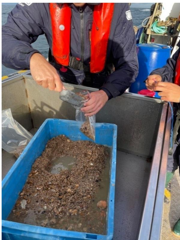
Figure 85 : prélèvements de sédiments (analyses de la granulométrie et de la matière organique) en mer dans le cadre du suivi des compartiments « Qualité des sédiments » et « Habitats et peuplements benthiques ».
