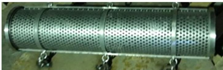
Figure 5 : cage dans laquelle les moules seront conditionnées et immergées dans le cadre du suivi du compartiment « Qualité de l'eau » par stations permanentes.
