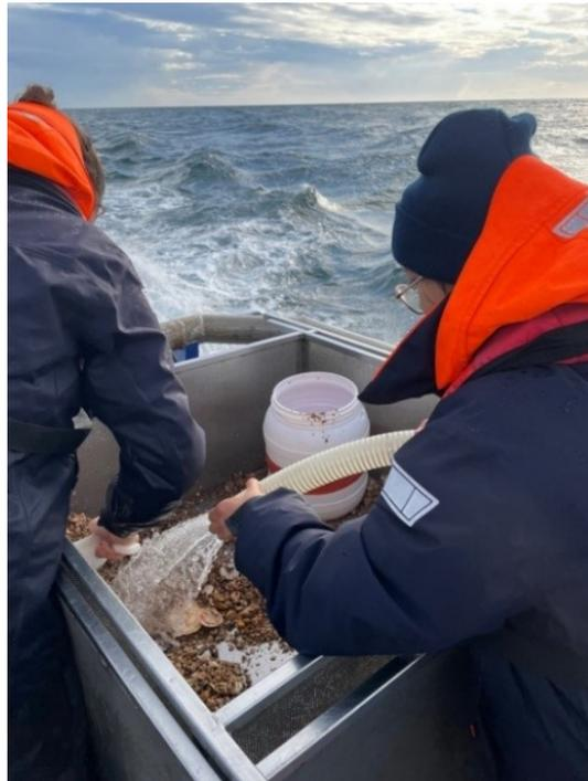
Figure 83 : tamisage de sédiment fin de récupérer la faune sur des tamis à ouvertures circulaires de 2 et 1 mm dans le cadre du suivi du compartiment « Habitats benthiques ».
