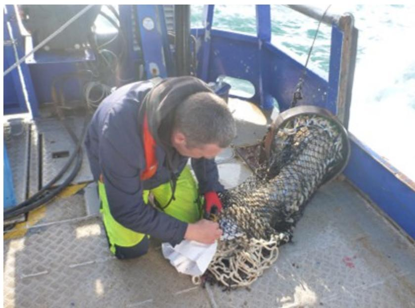
Figure 20 : drague Rallier du Baty utilisée dans le cadre du suivi des compartiments « Qualité des sédiments » et « Habitats benthiques ».
