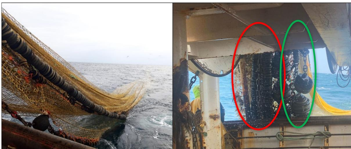
Figure 106 : virage du chalut canadien équipé d'un racleur au cours de la campagne d'été 2022 pour le compartiment « Poissons, Mollusques et Crustacés » Sinay©. La photo de gauche est une vue d'ensemble du chalut canadien lors du virage. La photo de droite est un zoom sur la partie bourrelet (cercle vert) et le racleur (cercle rouge), ce dernier étant fixé sous la partie inférieure des rondelles du bourrelet.
