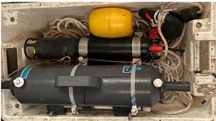
Figure 61 : système de « rosette » comprenant une bouteille de prélèvement de type Niskin en téflon, d'une contenance 5 L et une sonde WiMo multi-paramètre dans le cadre du suivi des compartiments « Qualité de l'eau » et « Communautés planctoniques ».
