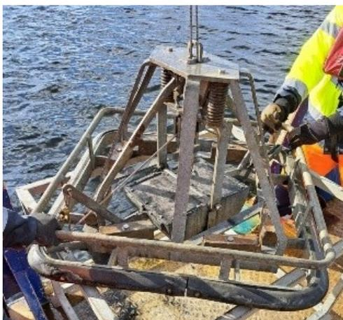
Figure 64 : benne Smith servant aux prélèvements des kystes phytoplanctoniques dans le cadre du suivi du compartiment « Communautés planctoniques ».
