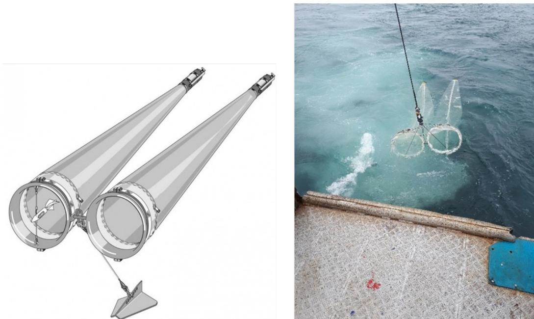
Figure 103 : filet Bongo à double collecteur servant au prélèvement de l'ichtyoplancton équipé d'un dépresseur et d'un volucompteur mécanique (Bionef©) dans le cadre du suivi du compartiment « Communautés planctoniques ».
