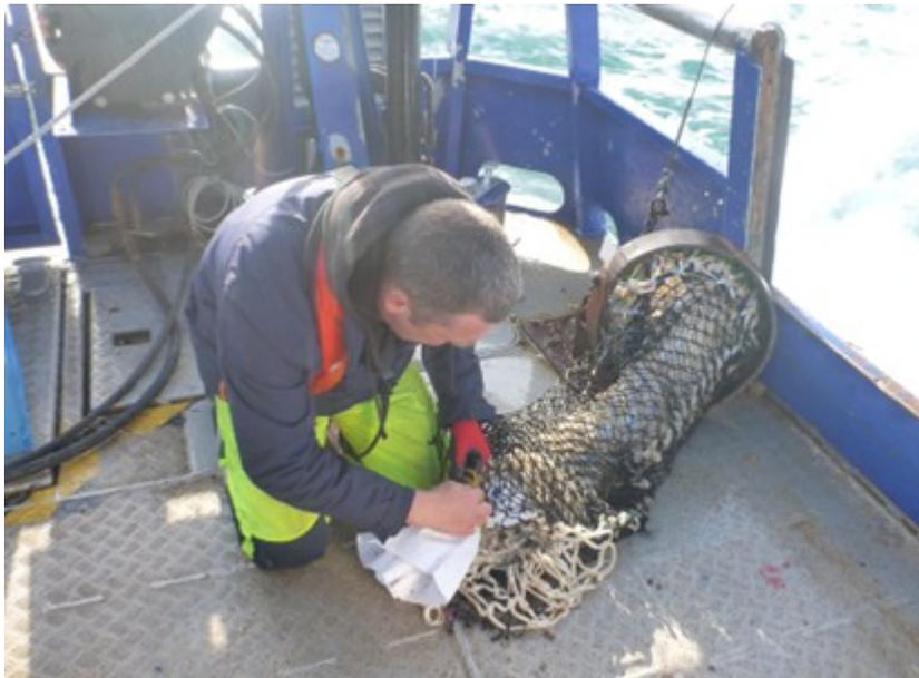
Figure 82 : drague Rallier du Baty utilisée dans le cadre du suivi des compartiments « Qualité des sédiments » et « Habitats et peuplements benthiques ».
