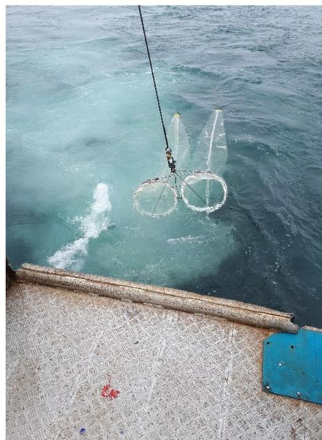
*Figure 62 : filet Bongo à double collecteur servant au prélèvement de l'ichtyoplancton équipé d'un dépresseur et d'un volucompteur mécanique (Bionef©) dans le cadre du suivi du compartiment « Communautés planctoniques ».*
