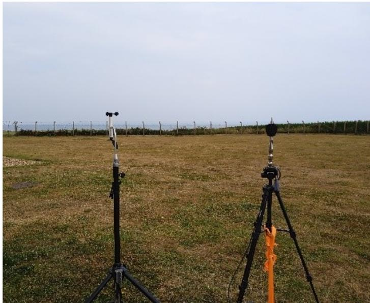
Figure 23 : photographie d'une installation de station météorologique (site de Port-en-Bessin).
