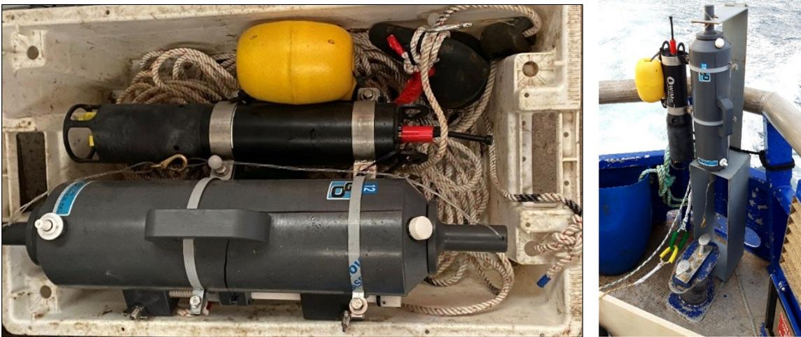
*Figure 4 : système de « rosette » comprenant une bouteille de prélèvement de type Niskin en téflon, d'une contenance 5 L et une sonde WiMo multi-paramètre dans le cadre du suivi des compartiments « Qualité de l'eau » et « Communautés planctoniques ».*
