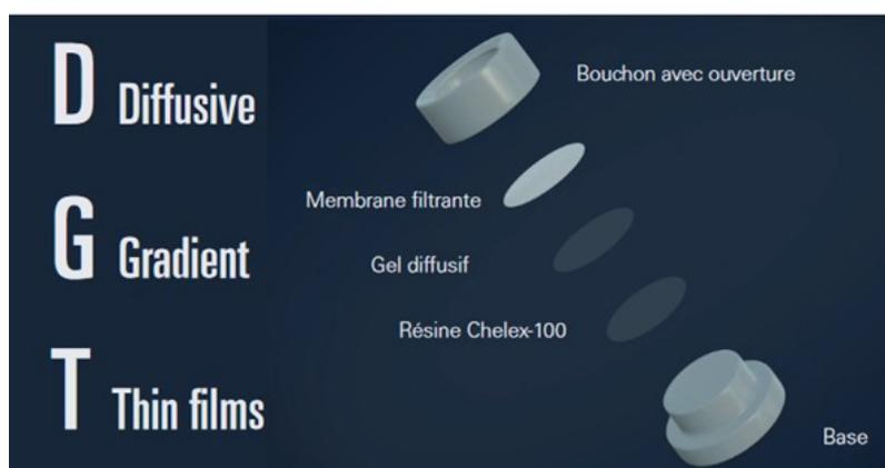
Figure 6 : structure d'un DGT (Source : Projet MONITOOL).
