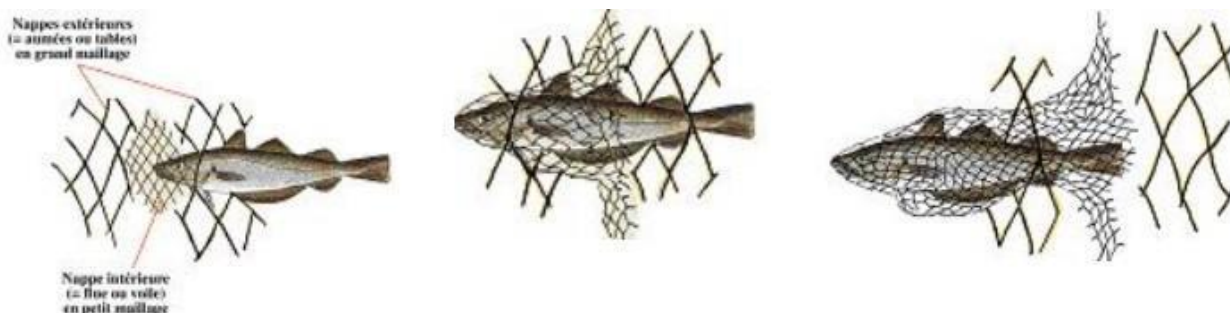
Figure 3 : Schéma de principe d'un filet trémail (Ifremer).
