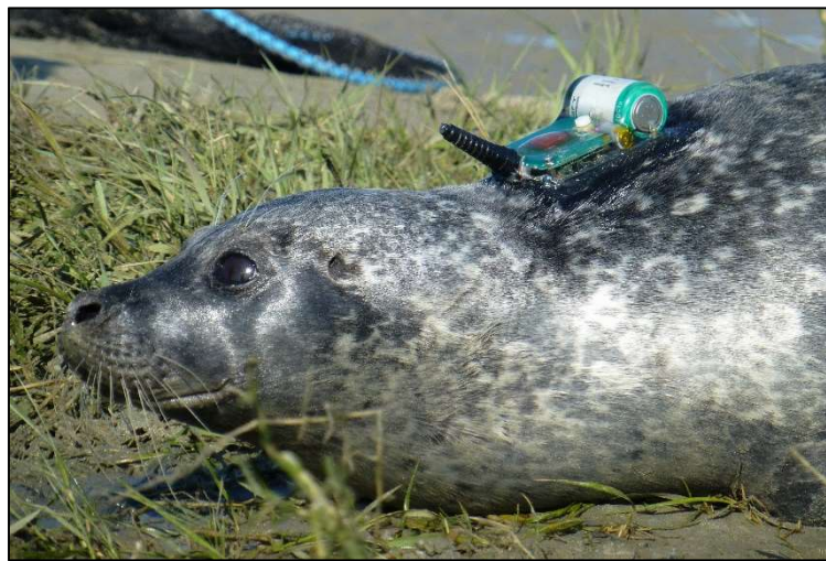
Figure 2 : Balises GPS/GSM collées à l'arrière de la tête d'un phoque veau-marin en baie des Veys, octobre 2020 (photo Yann Planque, La Rochelle Université).
