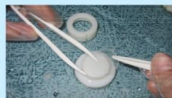
Figure 3 : DGT en cours de montage
