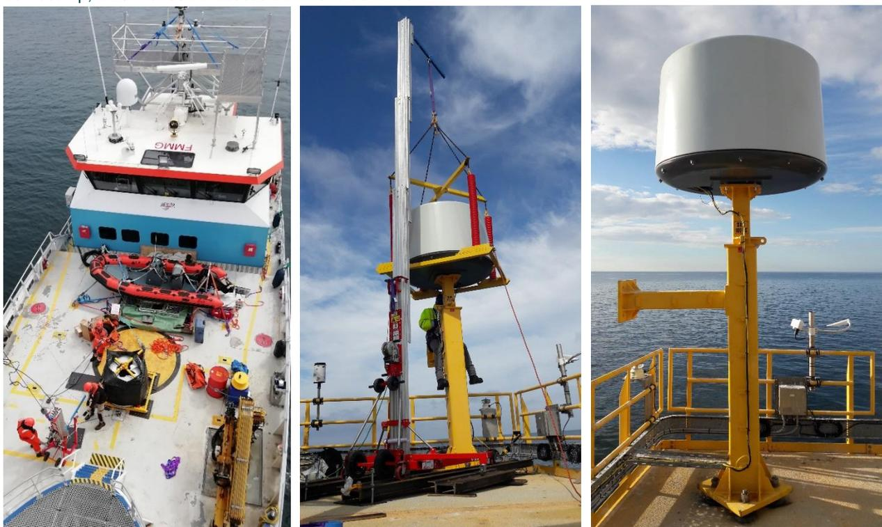
Le suivi est effectué dans un volume de rayon de 6 km autour du mât de mesure (voir paragraphe 2.2.3.2), tronqué par un secteur aveugle de 120° lié à l'occultation du faisceau par la plateforme (container, grue, mât vertical, voir Figure 1). Cette contrainte d'installation, inhérente à tout suivi sur plateforme offshore, autorise néanmoins un grand volume de détection et n'affecte pas la représentativité des données enregistrées.
