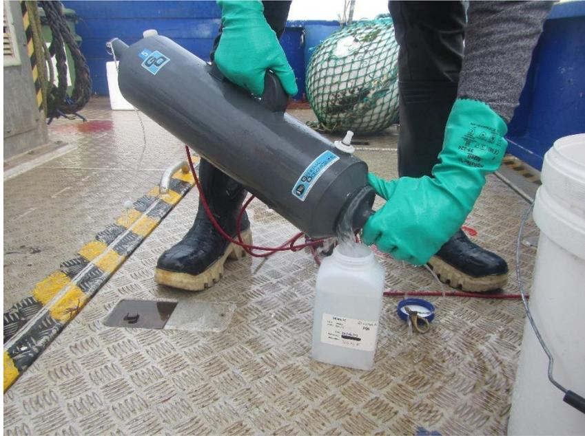
Figure 9 : Collecte d'un échantillon d'eau à l'aide d'une bouteille Niskin (TBM environnement)
