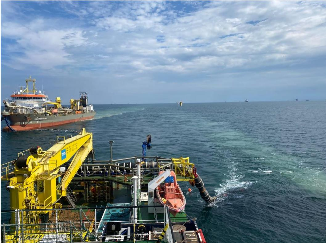
Figure 23 : Panache turbide observé lors d'une opération de ballastage.
