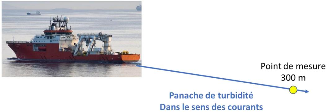
Figure 4 : Schéma de mesure de la turbidité par rapport aux travaux
