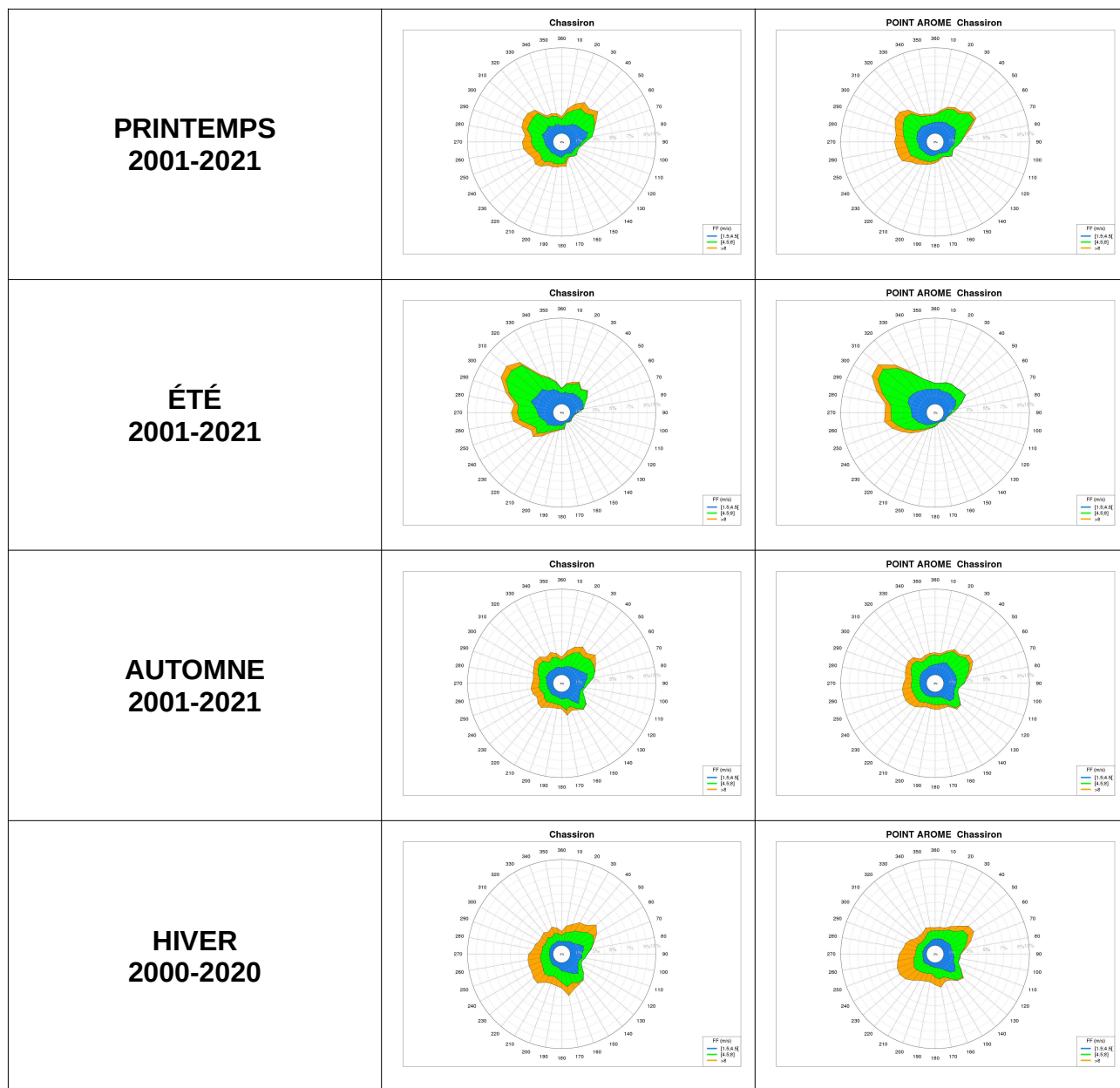
Illustration 4.5 : Roses saisonnières des vents horaires du point d'observation (à gauche) et du point AROME (à droite) sur la période 2000-2021
