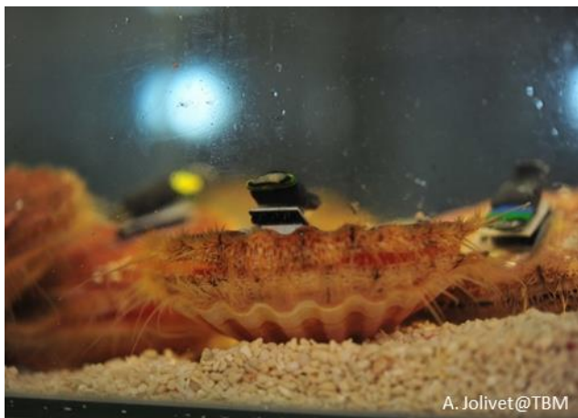
Figure 4 : Fixation des accéléromètres sur les coquilles Saint Jacques et dispositif expérimental utilisé
