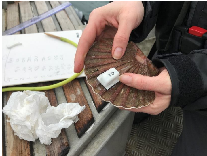
Figure 3 : Fixation d'un accéléromètre sur une coquille Saint Jacques
