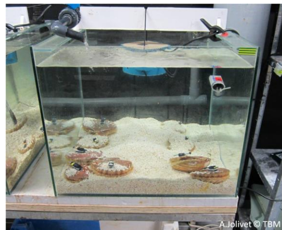
Figure 4 : Fixation des accéléromètres sur les coquilles Saint Jacques et dispositif expérimental utilisé
