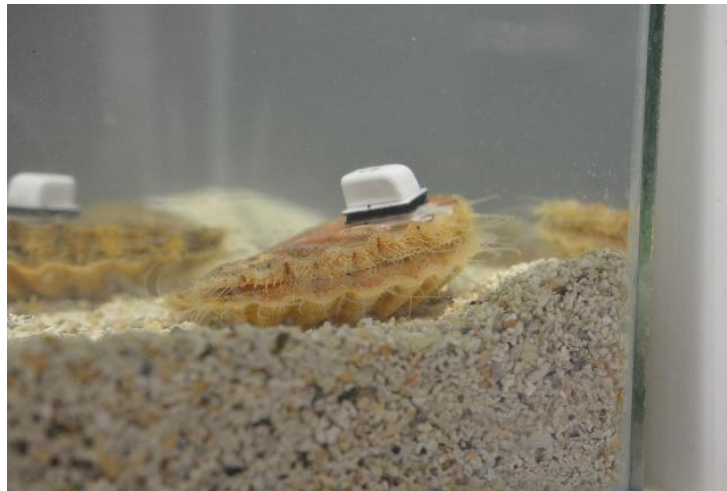
Figure 16 : Fixation des accéléromètres sur les coquilles Saint Jacques
