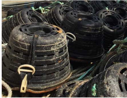
FIGURE 12 : ILLUSTRATION D'UN CASIER A BULOTS. CHAQUE FILIERE EST COMPOSEE DE 12 CASIERS IDENTIQUES.
