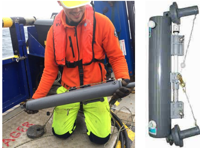
Photo 5 : Caractéristiques de l'équipement de prélèvement d'eau (bouteille Niskin)
