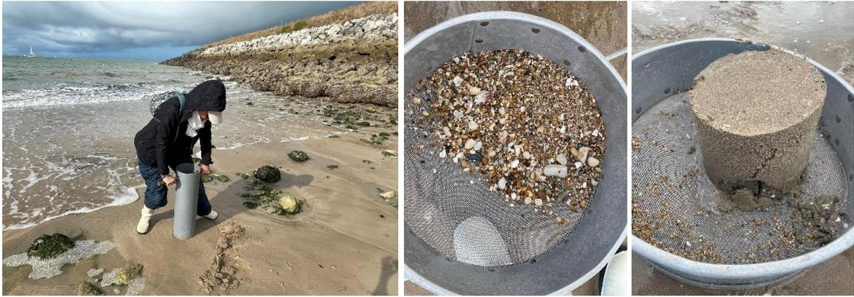
Figure 3 : Prélèvements de sédiment, refus de tamis et illustrations de la mission (source : setec énergie environnement, 2023)
