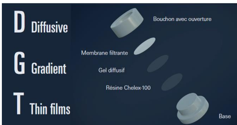
Figure 5 : Composition d'un DGT pour les composants métalliques (source : Projet MONITOOL)
