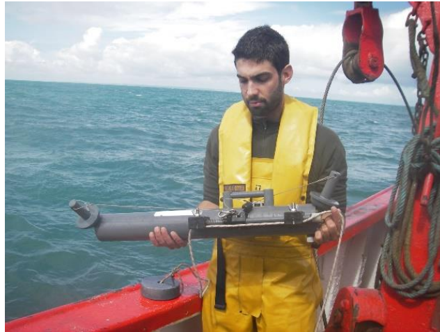
Photo 4 : Bouteille Niskin armée et prête à l'emploi (source : setec énergie environnement)
