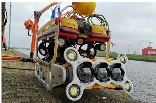
Figure 10 : Photogrammétrie : système Orus et exemple de rendu (Source : Comex)
