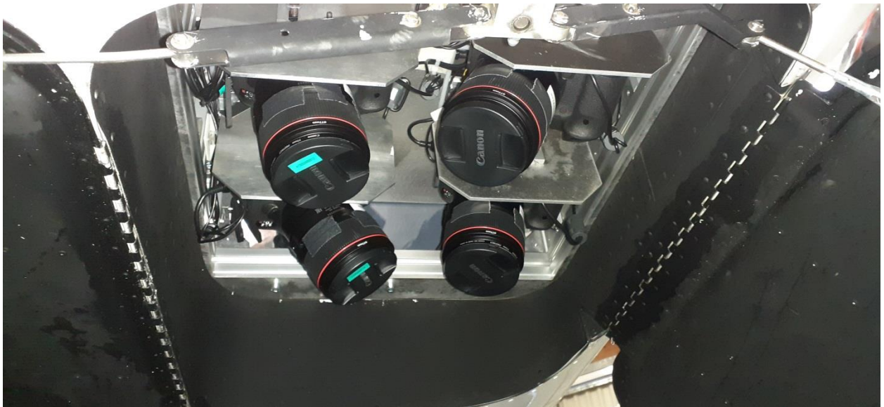
Figure 8 : Système STORMM® installé dans l'aéronef – vue du dessous
