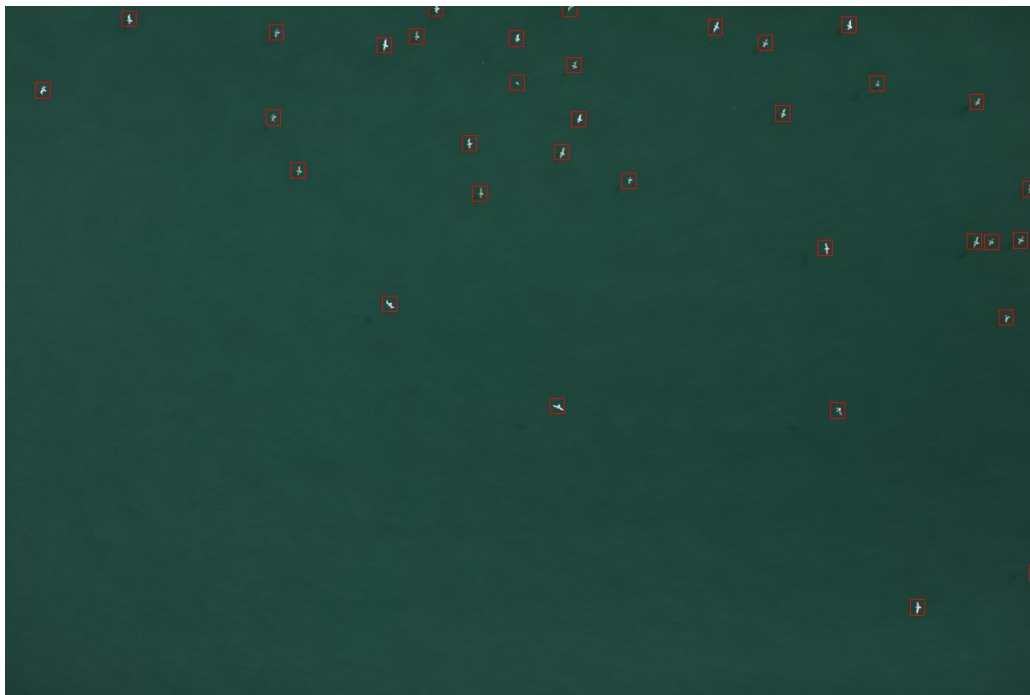
Figure 15 : Image issue de STORMM® avec application de l'algorithme de prétraitement automatique : 33 cibles d'intérêt sont détectées et localisées
