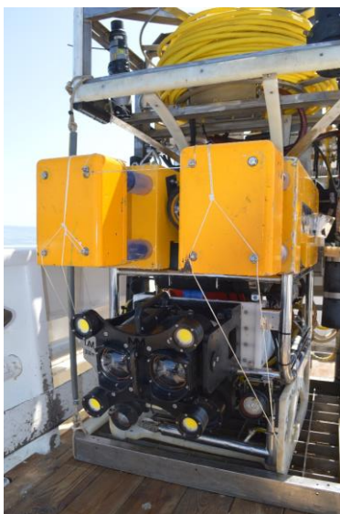
Figure 5 : Photogrammétrie : système Hydro300 et exemple de modèle 3D (source : setec énergie environnement, 2023)
