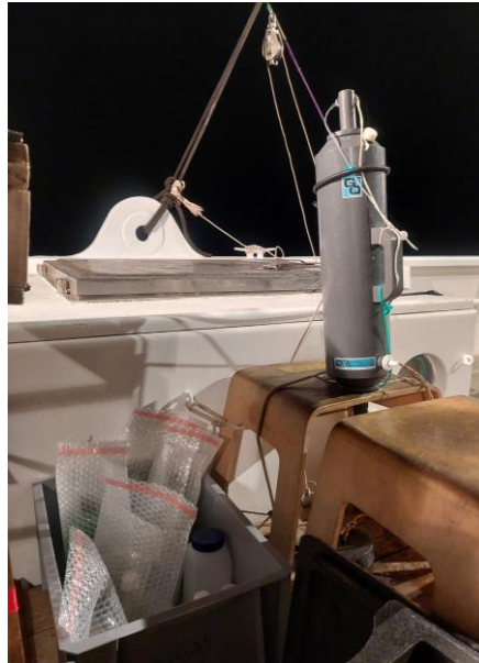
Photo 4 : Poste de travail pour la qualité de l'eau lors de la campagne de mars 2023 : poulie de mise à l'eau, bouteille Niskin sur son support et flaconnages Eurofins (source : setec énergie environnement, 2023)
