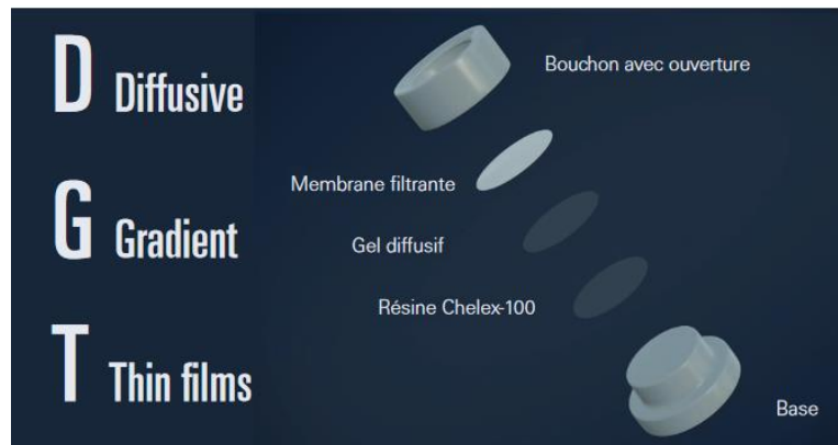
Figure 3 : Composition d'un DGT pour les composants métalliques (source : Projet MONITOOL)
