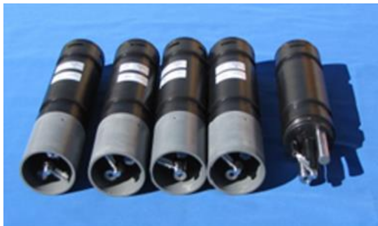
Photo 3 : Sonde wimo plus, EXO (sur la page précédente) et SAMBAT (ci-dessus) (source : NKE/EXO)
