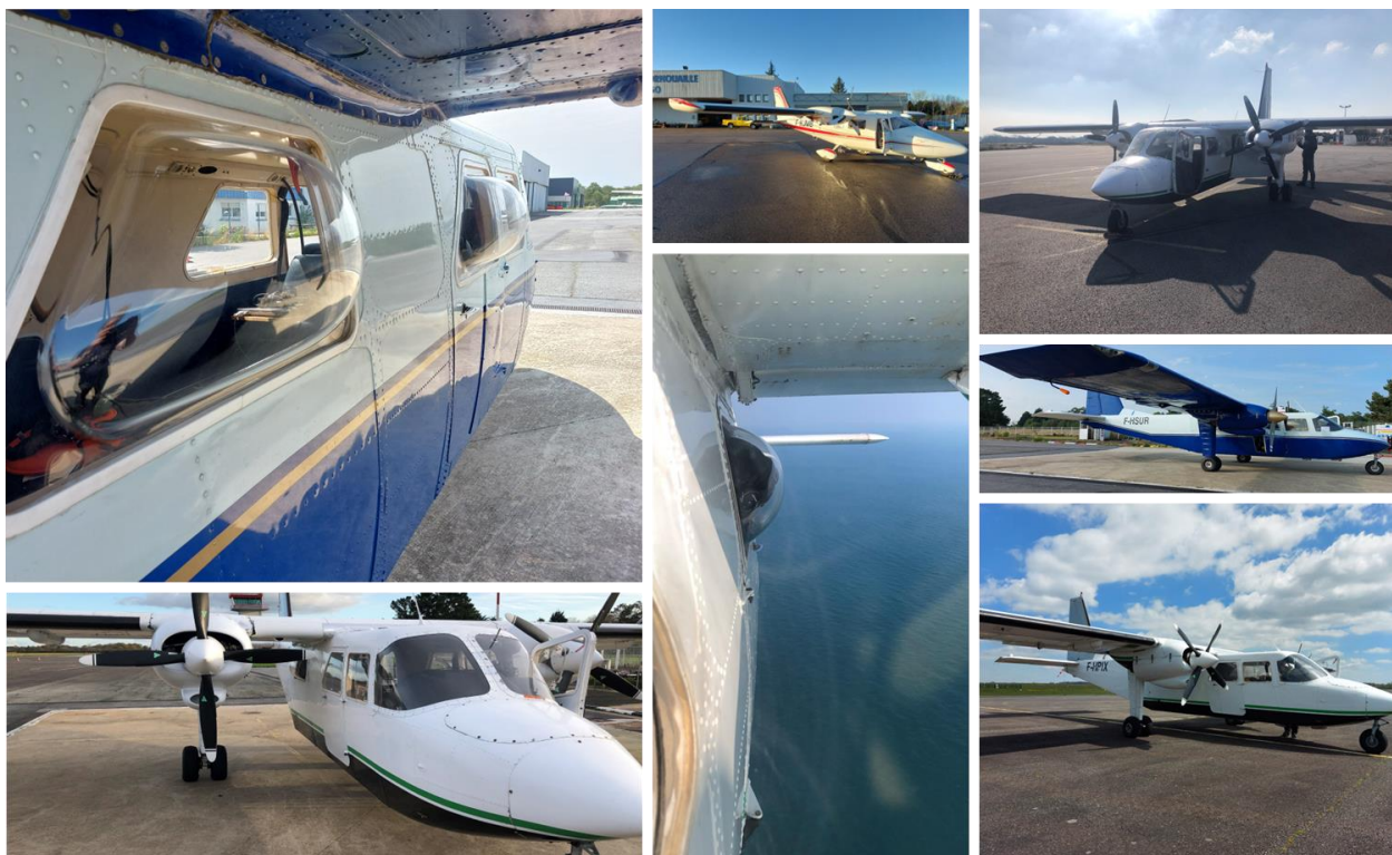
Figure 2 : Avions de type BN2 British Norman Islander utilisé pour les suivis et Hublots bulles pour l'observation aérienne (Photos : SEE)
