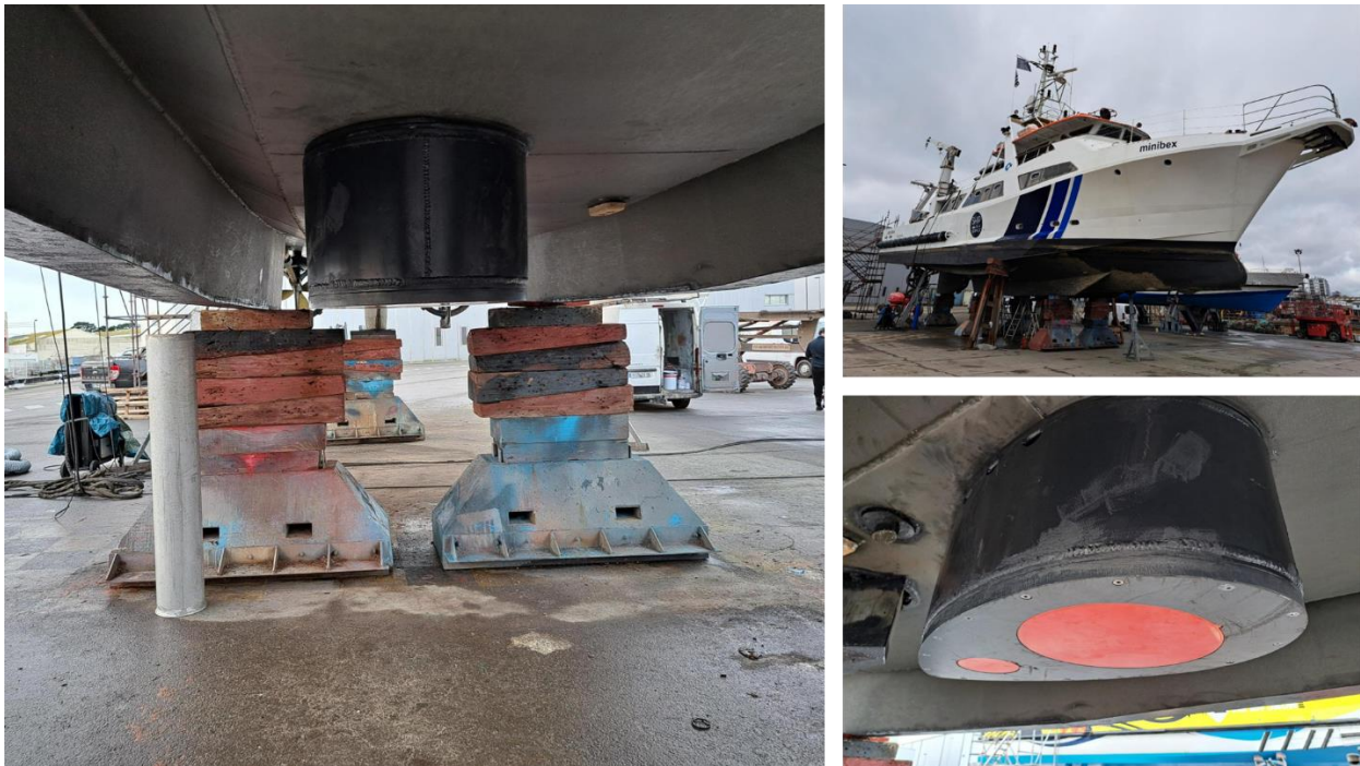
Figure 10 : Illustration du matériel qui sera déployé (2 transducteurs 38 et 200 kHz) et de son intégration sur le navire MINIBEX.
