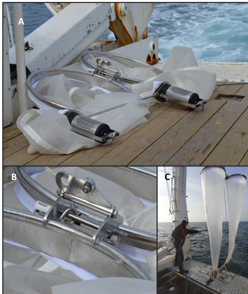
Figure 6 : A) Double filet Bongo auquel un dépresseur est ajouté pour créer une portance négative supplémentaire. Un débitmètre est positionné dans l'embouchure d'un des deux filets pour mesurer le volume effectivement filtré par l'engin. B) Fixation d'une sonde ( T^{\circ}\text{C} , S_{\text{‰}} , Profondeur) sur le cadre métallique pour restituer objectivement la trajectoire effectuée par l'engin au sein de la masse d'eau. C) Filet bongo déployé (source : SEE).
