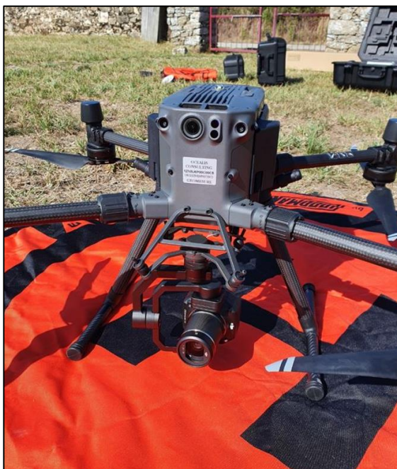
Photo 1 : Drone DJI Matrice300 RTK d'Ocealis-Consulting, équipé de la P1 (source : ©Ocealis-Consulting, 2022)
