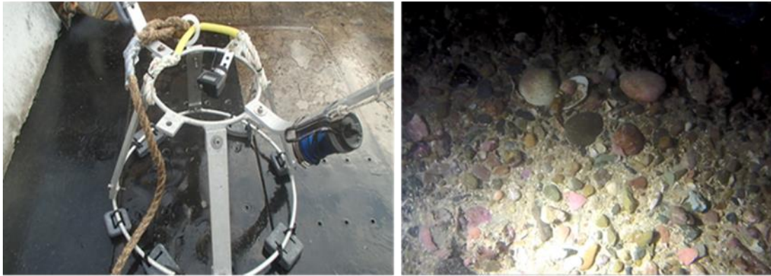
Photo 4 : Baty cylindro-conique permettant une prospection stationnelle (à gauche) et résultat de vidéo GoPro (à droite) (source : setec énergie environnement, 2022)
