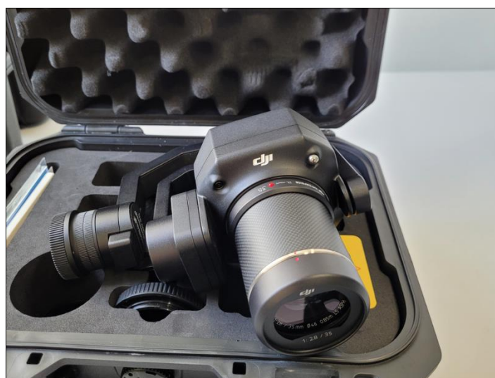
Photo 3 : Nacelle DJI P1 dédiée photogrammétrie (source : ©Ocealis-Consulting, 2022)
