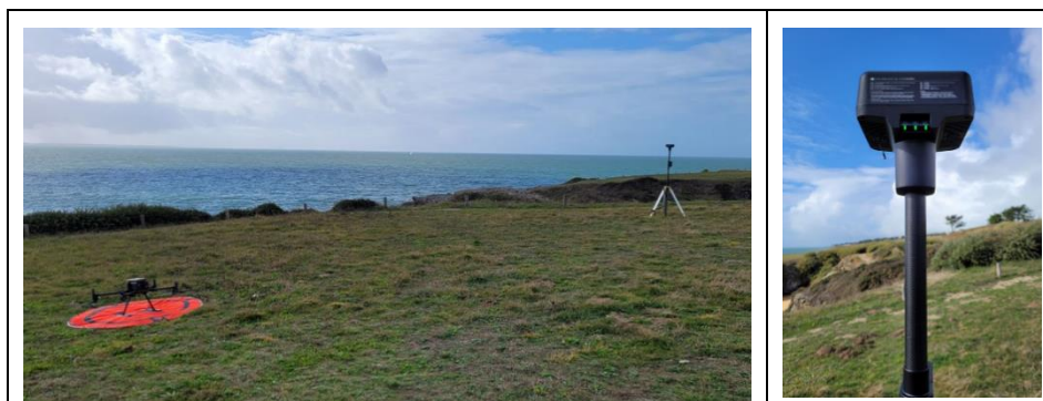
Photo 2 : Base RTK du Matrice300 (source : ©Ocealis-Consulting, 2022)
