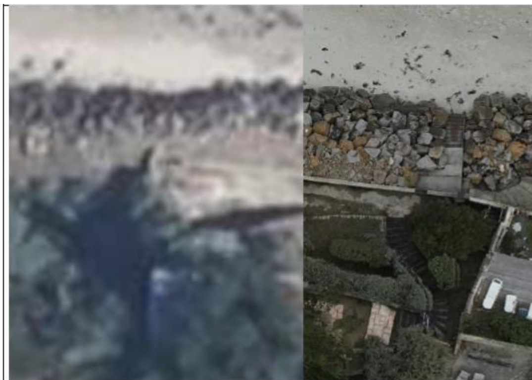
Figure 2 : Comparaison des résolutions (pixel 20 cm à gauche, 2 cm à droite)
