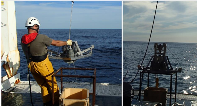
Photo 2 : Utilisation de la benne Day lestée (type Van Veen) (source : setec énergie environnement, 2022)
