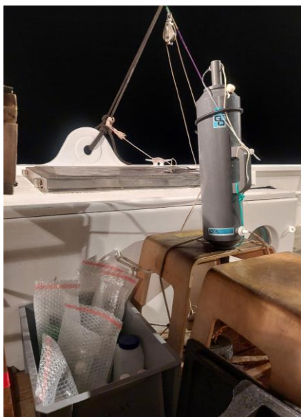
Photo 4 : Poste de travail pour la qualité de l'eau lors de la campagne de mars 2023 : poulie de mise à l'eau, bouteille Niskin sur son support et flaconnages Eurofins (source : setec énergie environnement, 2023)
