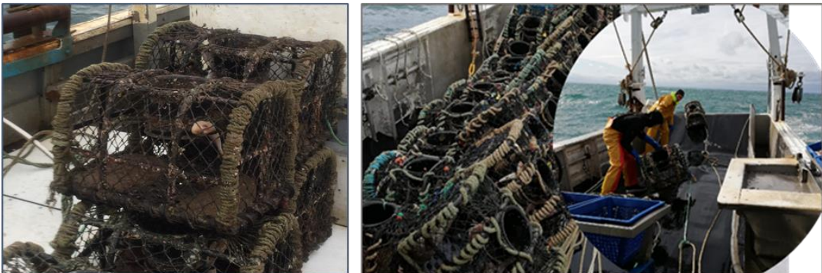
Figure 12 : Illustration du matériel de pêche « casiers à crustacés ». Des casiers de type hémicylindrique sont montés en filière.
