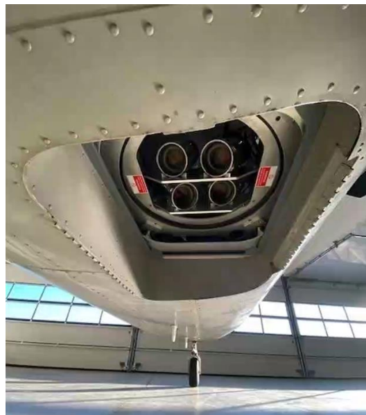
Figure 46 : Vue caméras sous l'avion (source: HiDef aerial surveying)
