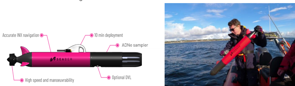
Figure 34 : Vue et mise en œuvre de l'AUV Seaber Yuco
