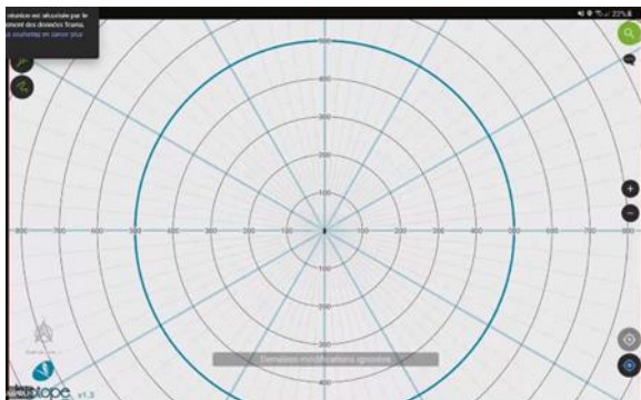
Figure 59 : Cadran géoréférencé du formulaire de saisie sur tablette de terrain. Le point noir au centre est la localisation du navire en navigation. Des cercles gris sont schématisés tous les 100 m à distance du navire.
