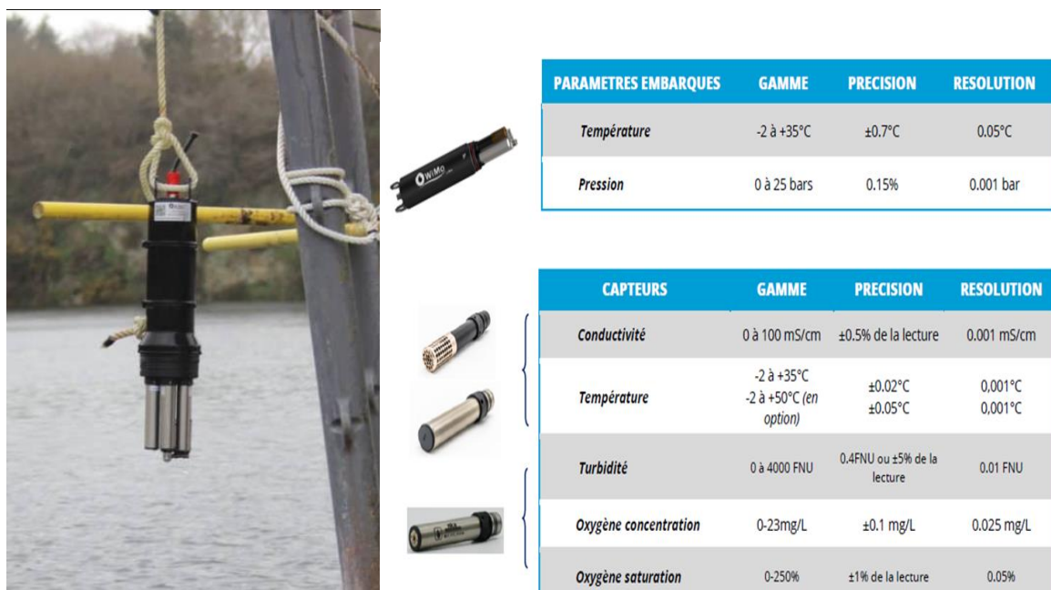
Figure 3 : Sonde Wimo et ses capteurs © NKE fabricants
