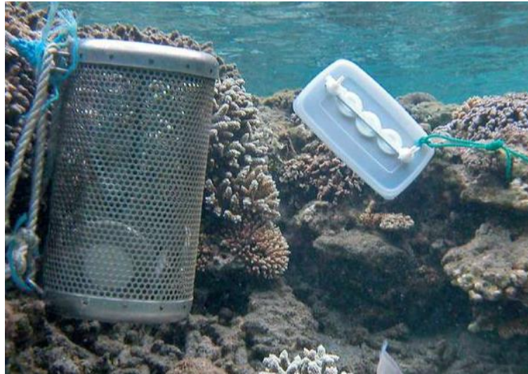
Figure 6 : Exemple de DGT et de POCIS posés en lagon (source IFREMER)
