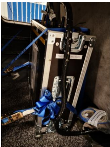
Figure 43 : Coffret intégrant l'ensemble des équipements informatiques, serveur, disques SSD installé dans un P68 (HiDef)
