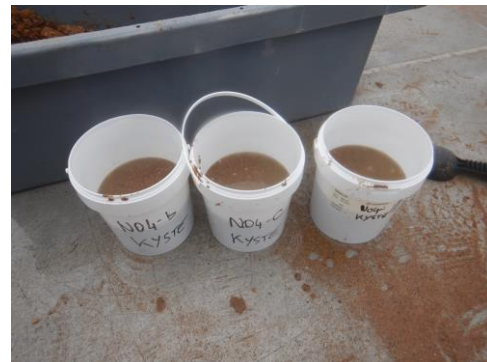
Conditionnement en pot de 2L pour analyse des kystes benthiques
