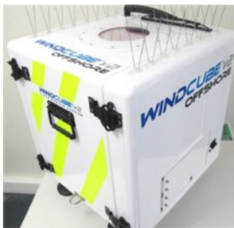
Illustration 6 : Photo d'un LiDAR Windcube V2 Offshore 8.66 identique à celui utilisé pour l'AO4.
