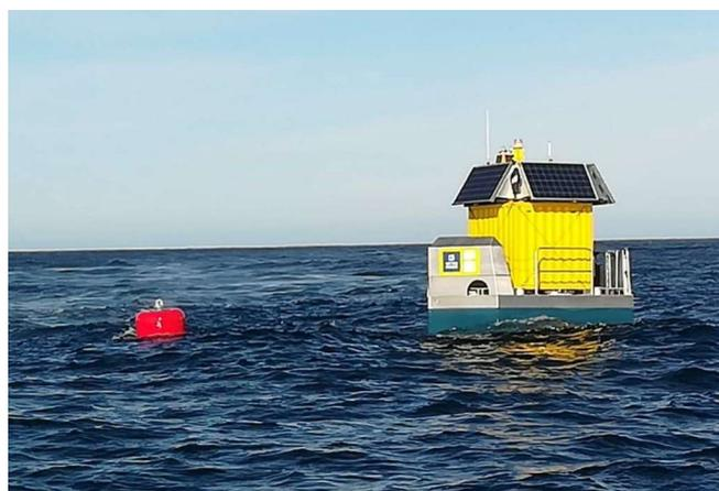
Illustration 1.2 : Photo d'une bouée exploitée par Akrocéan du même type que celle installée sur le site de l'AO7. Cette bouée embarque notamment un LIDAR, une station météorologique et des capteurs océanographiques.
