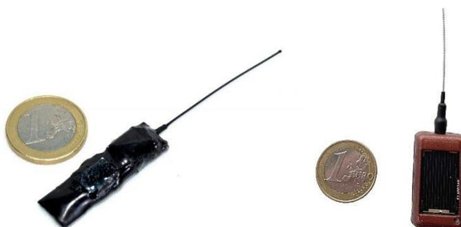
**Figure 2** : gauche - GPS Pathtrack de 5g muni de panneaux solaires. Ce type de GPS peut transmettre les données enregistrées via UHF à une station réceptrice dans un rayon d'1km ; droite - GPS Ornitela OT10 de 10g muni de panneaux solaires et capable de transmettre les données via le réseau GSM. Ce GPS est associé à un accéléromètre et un capteur de pression. Photos ©Pathtrack Ltd, Ornitela.
