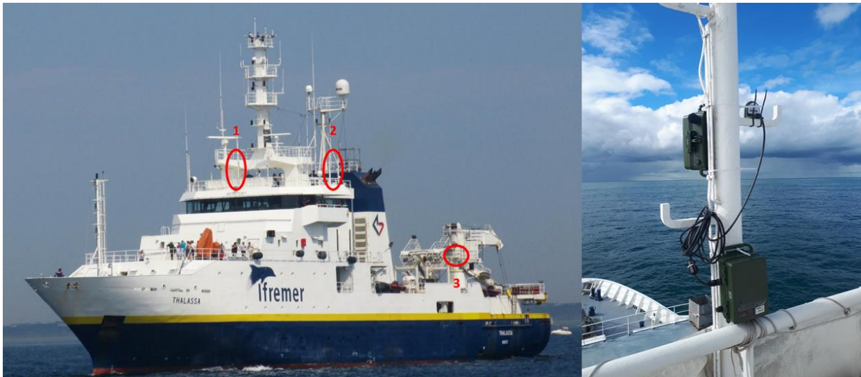
Figure 5 : Positions des capteurs (SM4-BAT et SM4-BIRD) sur le bateau Thalassa (IFREMER) utilisé pour les campagnes MEGASCOPE.
