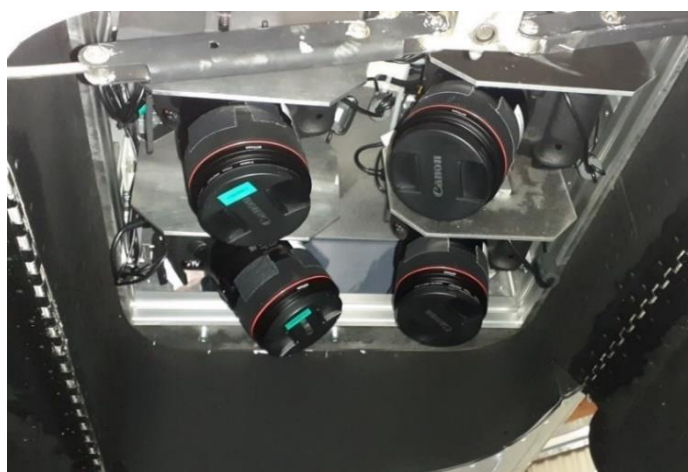
Figure 6 : Système STORMMM® installé dans l'aéronef vu du dessous – Hytech-Imaging / Observatoire Pelagis
