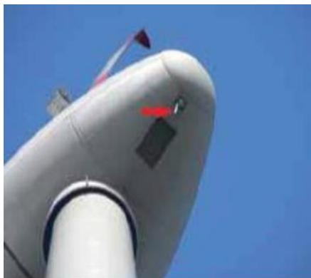
*Figure 37 : Microphone d'enregistrement à distance placé sur le dessous de la nacelle. Il est relié à un détecteur automatique installé à l'intérieur de la nacelle. Photo : L. Bach ©*
