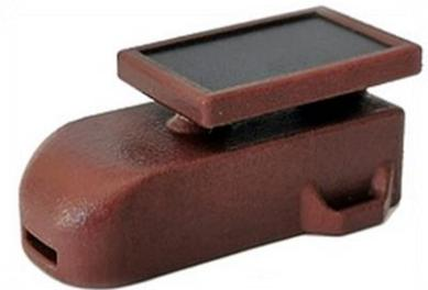
Ces balises GPS sont programmées pour enregistrer la position géographique des individus et envoyer ces positions à une plateforme de téléchargement via le réseau GSM. Grâce aux panneaux solaires et au téléchargement régulier des données, les balises doivent permettre l'acquisition de données pendant une année, afin de connaître la distribution spatiale des oiseaux reproducteurs pendant la période de reproduction mais également au cours de la dispersion postnuptiale.
