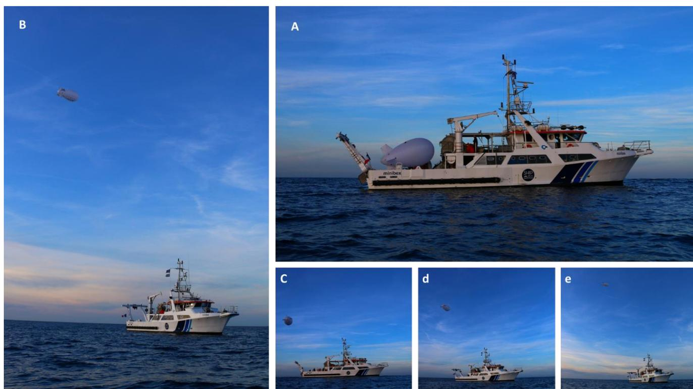
Figure 3 : Illustrations présentant le déploiement du matériel d'enregistrement suivant que le navire soit en transit (A) : le ballon est alors sécurisé sur le pont arrière du navire ; ou positionné sur un point d'écoute fixe (B) : le ballon est alors déployé. Les images c, d et e illustrent l'envol et la prise d'altitude du ballon et son positionnement vis-à-vis du navire.
