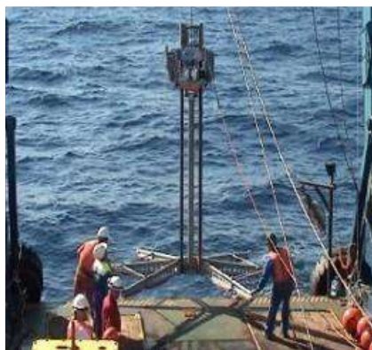
Figure 6 : Photographie du vibrocarottier GeoCorer (source : Tecnoambiente)
