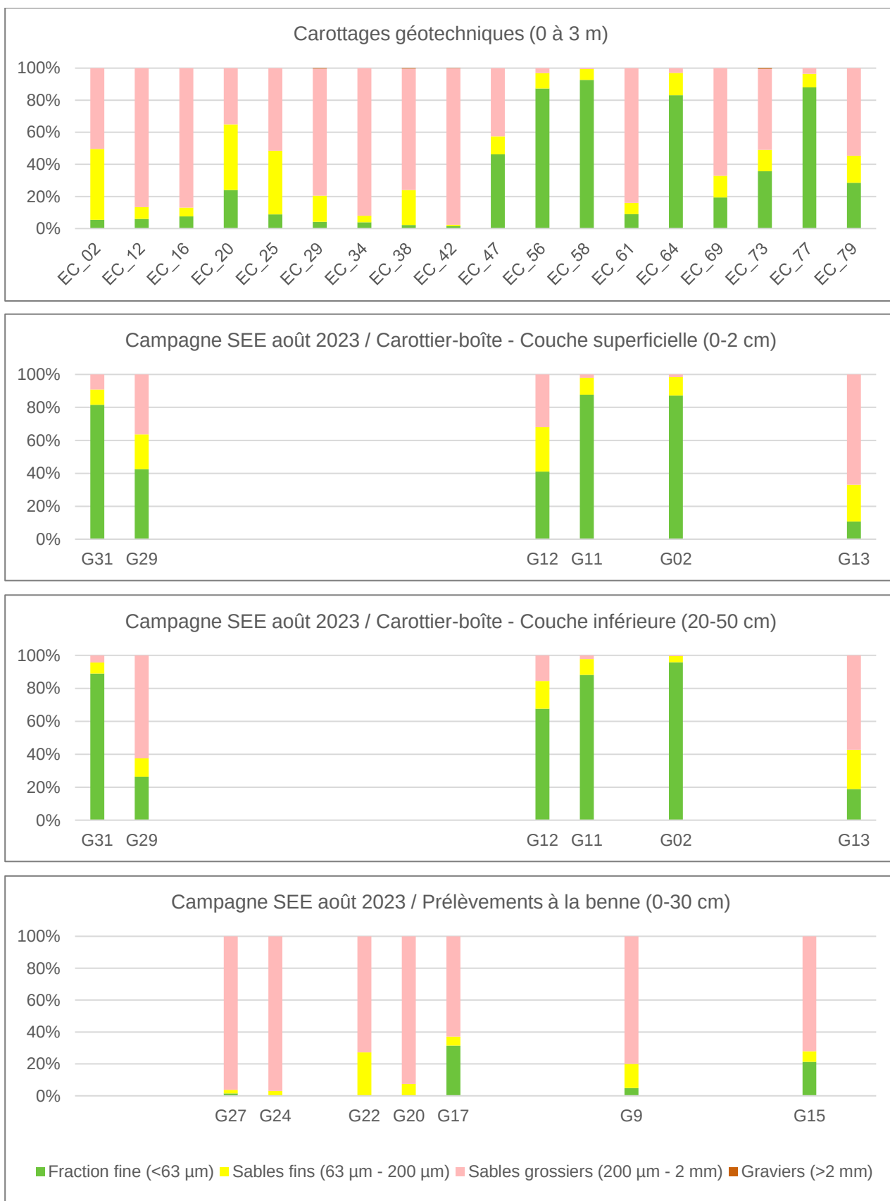
Figure 9 : Comparaison des classes granulométriques du sédiment issu des carottages géotechniques (Tecoambiente) et des prélèvements réalisés par SEE en août 2023
