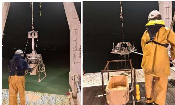
Figure 3. À gauche, mise à l'eau du carottier boîte et à droite, benne Day à sa sortie de l'eau (setec énergie environnement, 2024)
